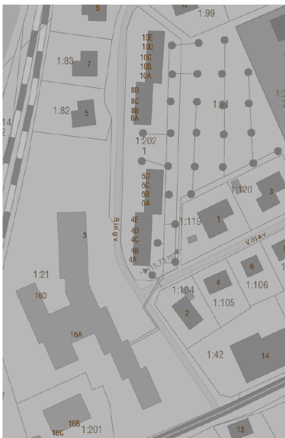
Figur 3.1. Skiss över föreslagen energiborrhålsplacering.
