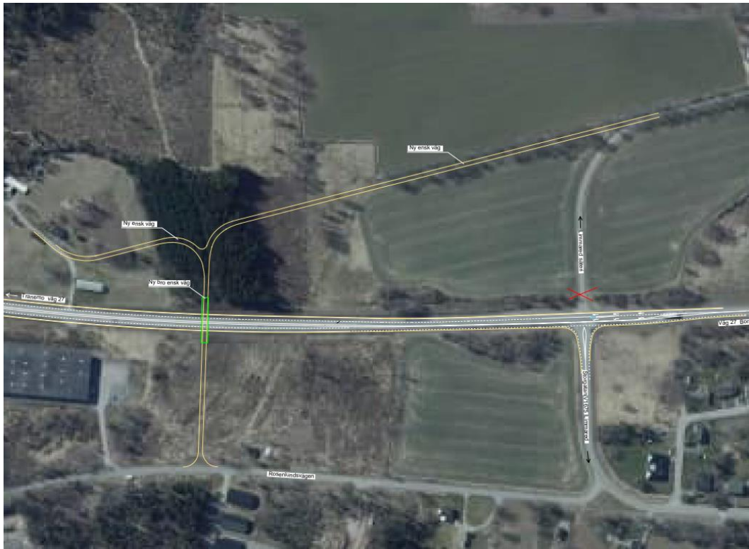
Figur 10. Exempel på åtgärder i korsning med väg 1675. Av skissen framgår även föreslagen placering av bro för enskild väg i söder. Vidare utredning får utvisa vilken utformning som är lämplig.
