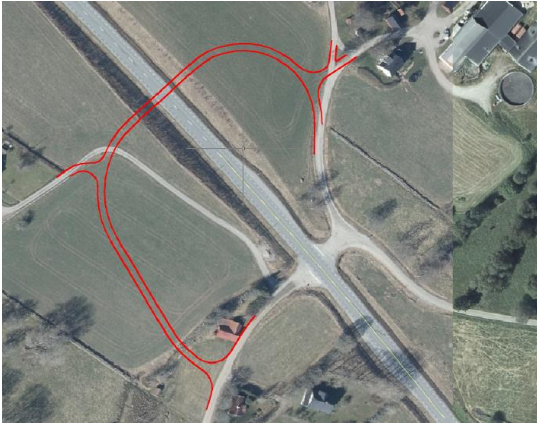
Figur 7. Exempel på placering och möjlig utformning i plan för planskildhet för enskild väg vid Bystad. Vidare utredning får utvisa vilken utformning som är lämplig. Bakgrundsbild: Lantmäteriet.
