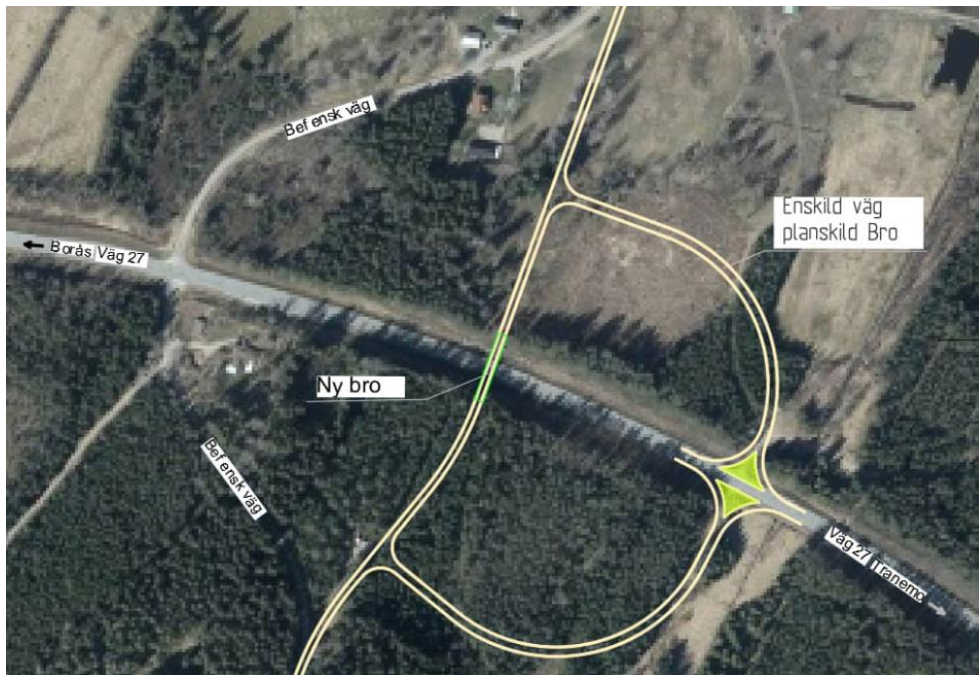
Figur 6. Exempel på placering och utformning i plan för bro för enskild väg vid Yttre Holm. Vidare utredning får utvisa vilken utformning som är lämplig. Bakgrundsbild: Lantmäteriet.
