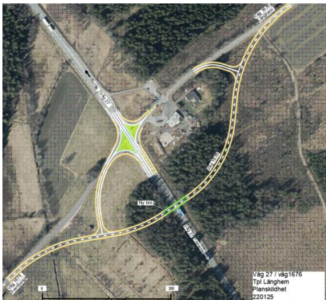
Figur 5. Exempel på möjlig utformning av planskildhet i korsningen med väg 1676. Tunnel för gång- och cykeltrafik med tillhörande gång- och cykelväg framgår ej av principförslag. Vidare utredning får utvisa vilken utformning som är lämplig. Bakgrundsbild: Lantmäteriet.
