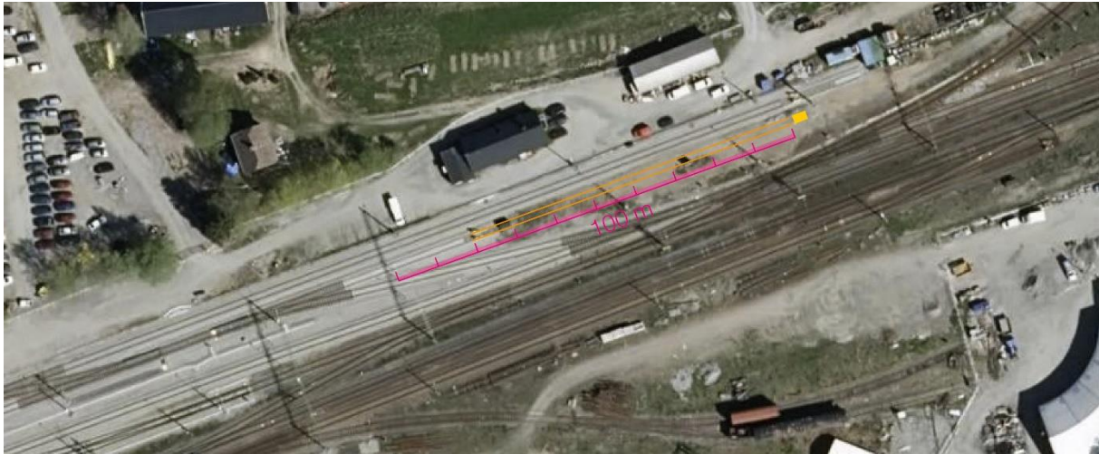
Figur 27 Illustrationen visar hur befintlig skyddsväxel kan förlängas till ett uppställnings-/vändspår för tåg till och från Kinnekullebanan.
