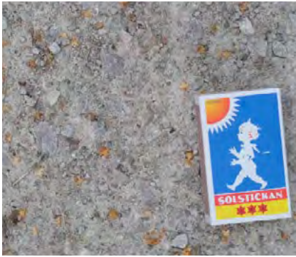
Figur 13. Beläggning av stenmjöl med kalk (kalkgrus), förmodligen 0-4 mm.
