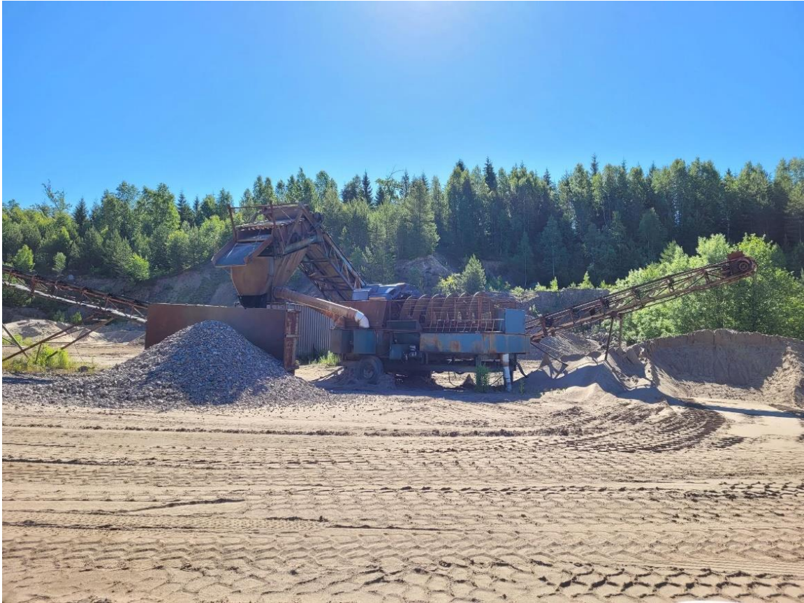
Figur 5. Anläggning för tvättning av sand- och moränmaterial.
