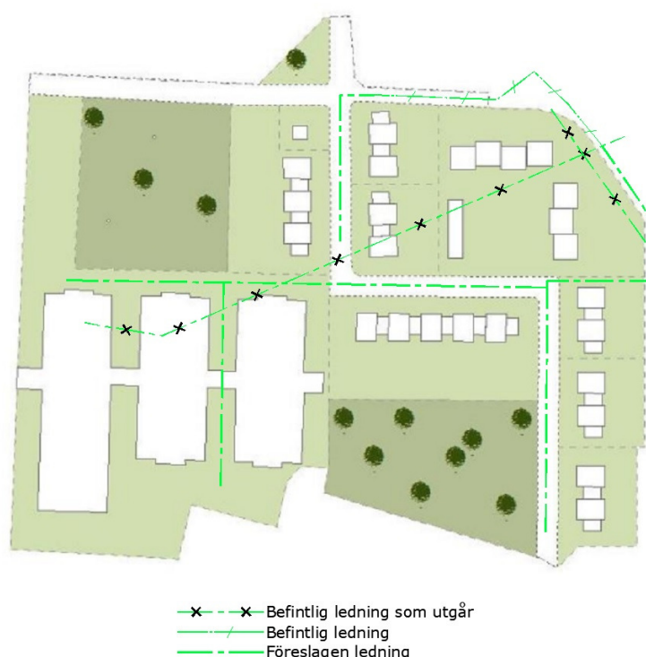
Figur 5 Förslag till utformning av dagvattennätet.
